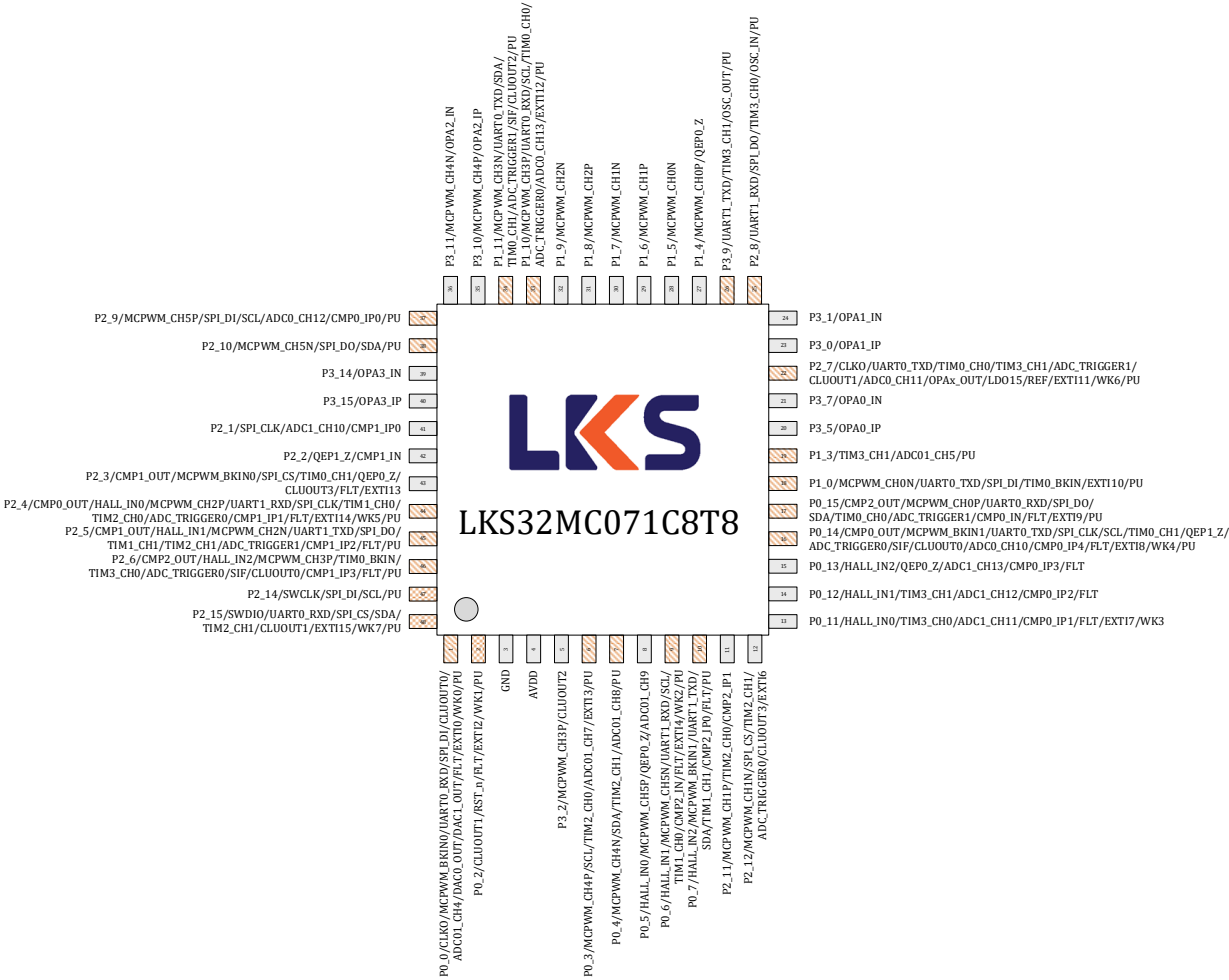
图 3-2 LKS32MC071C8T8 管脚分布图
